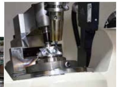
5軸MCによる削出(削出法)
